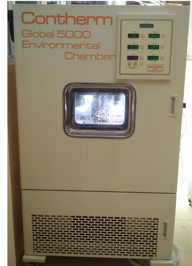
Tủ ôn ẩm Contherm global 5000: - Điều khiển nhiệt độ từ : -40^{\circ}\text{C} \div 100^{\circ}\text{C} - Độ ẩm từ: 35-98%
