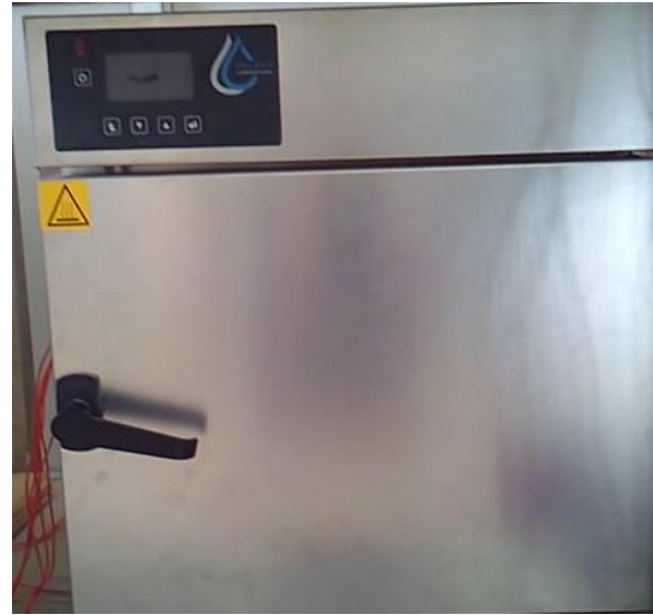
Tủ nhiệt POL-EKO: điều chỉnh nhiệt độ lên đến 250^{\circ}\text{C}
