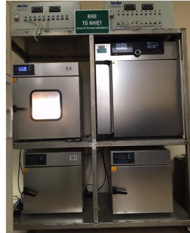
Hệ thốn thử nghiệm độ duy trì quang thông của nguồn sáng LED
