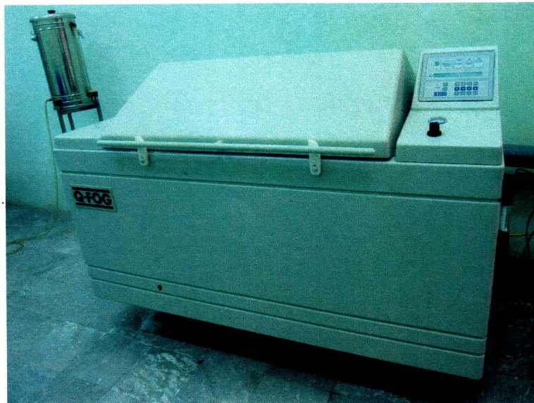
Thiết bị phun mù muối: Q-FOG Cyclic Corrosion Tester CCT 600
