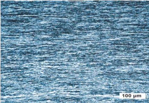
Lichtmikroskopische Aufnahme eines Mo-Blechtes (spannungsarm gegläht) Optical micrograph of a Mo sheet metal (stress relieved)
