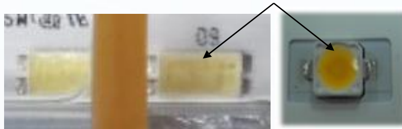
Hình 2. S xu t hi n THAY i màu trong PKGs LED (các gói Led)
